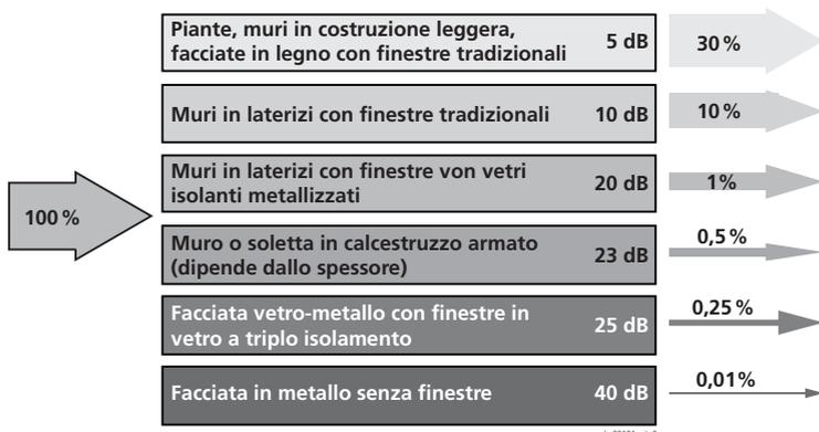
Fig. 3.15: Attenuazione dei segnali HF dovuta a pareti, finestre e piante
